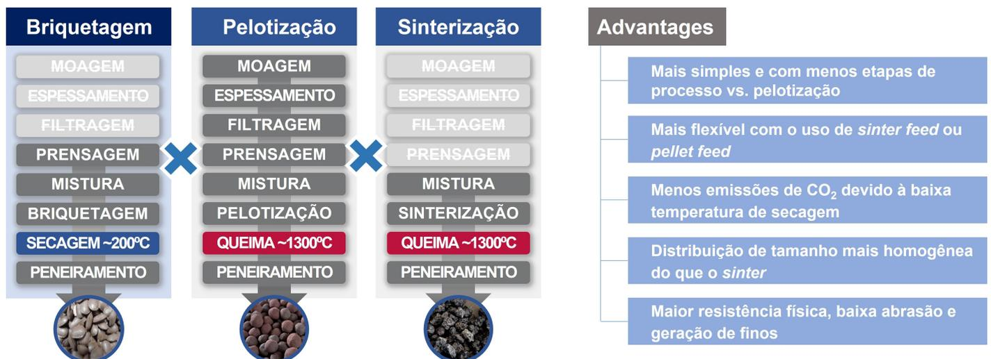
Figura mostra as vantagens da briquetagem em relação à pelotização e à sinterização
