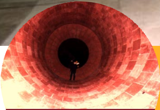
Tampak bagian dalam Tanur Pereduksi No.2 dengan batu tahan api yang baru. Inside view of newly relined Reduction Kiln No. 2.
