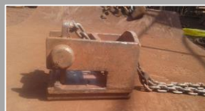
Exemplo de tenaz não adequada
