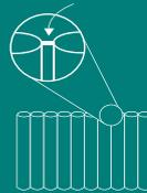
Finalizamos, em maio, a soldagem dos conectores e a fixação dos painéis metálicos (chapas) que impedirão que o rejeito passe entre os tubos cravados.
